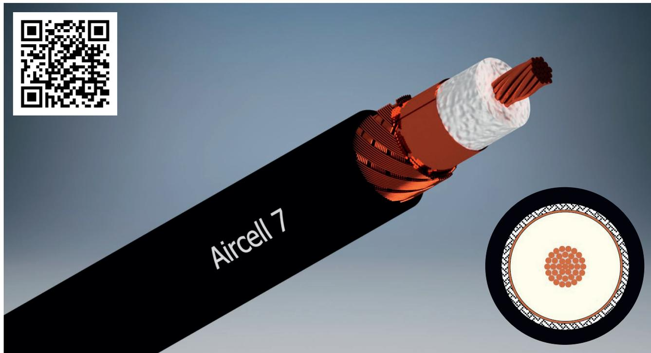
Aircell 7 ist ein hochflexibles Koaxialkabel für den Frequenzbereich bis 6 GHz. Die im Verhältnis zum Durchmesser sehr niedrige Dämpfung und der kleine Biegeradius machen den Einsatz für viele Anwendungen in der Hochfrequenztechnik interessant und empfehlenswert.
